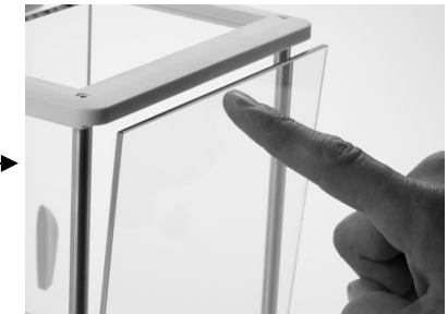
2) Installez les panneaux avant et arrière – Introduisez le bord inférieur dans la rainure et appuyez jusqu'au blocage.
